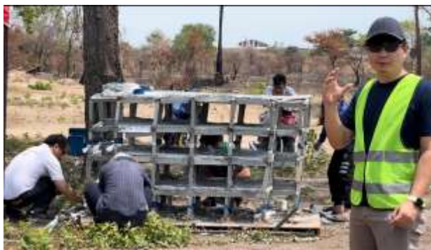
รูปที่ 6 การเตรียมระเบิดแบบจำลองอาคารคอนกรีตเสริมเหล็ก
