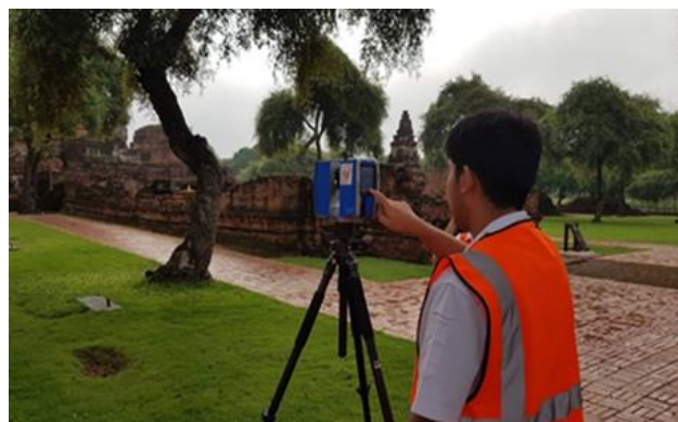
รูปที่ 2 การเก็บข้อมูลด้วยกล้อง FARO focus3D x330
