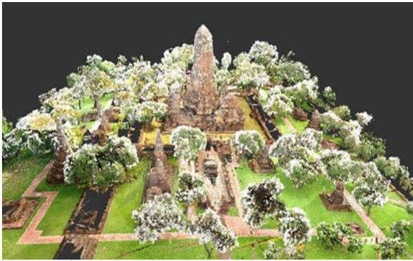
รูปที่ 3 ข้อมูลกลุ่มจุด 3 มิติ ( point cloud data ) ของวัดพระราม
