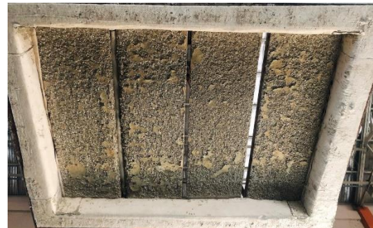
รูปที่ 7 การหลุดร่อนออกของคอนกรีตบริเวณท้องพื้นจากการทดสอบสภาวะเพลิงไหม้
