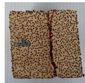
รูปที่ 19 การวิบัติเนื่องจากการรับแรงเฉือนในขนานเสี้ยนของตัวอย่าง P-C-60-30
