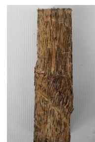
รูปที่ 15 การวิบัติเนื่องจากการรับแรงอัดขนานเสี้ยนของตัวอย่าง P-C-60-30
