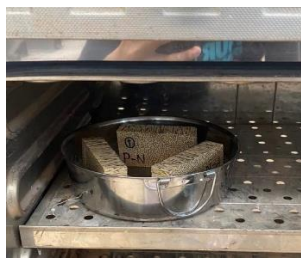
รูปที่ 13 การทดสอบสมบัติทางกายภาพของไม้ปาล์มน้ำมัน
