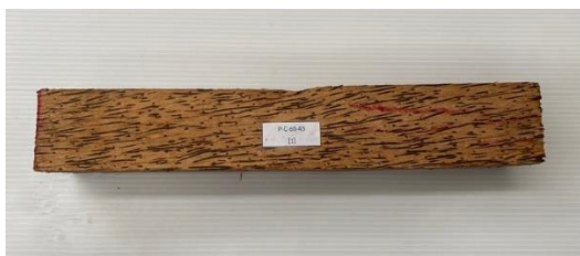
รูปที่ 21 การวิบัติเนื่องจากการรับแรงดัดโค้งงอของตัวอย่าง P-C-60-45
