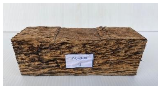
รูปที่ 17 ชิ้นตัวอย่างที่ผ่านการทดสอบของกำลังต้านทานแรงอัดตั้งฉากเสี้ยน ตัวอย่าง P-C-60-30
