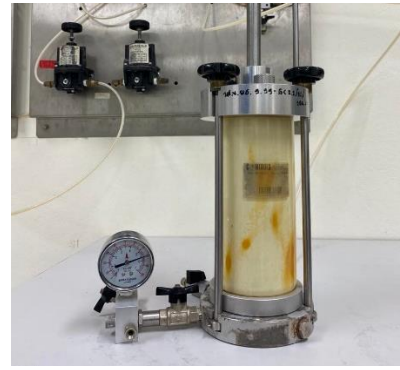
รูปที่ 11 การอัดน้ำยางพาราเข้าสู่เนื้อไม้ด้วยแรงดัน
