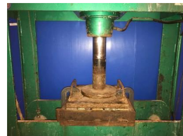
รูปที่ 12 การบีบอัดชิ้นตัวอย่างด้วยเครื่องอัดอเนกประสงค์
