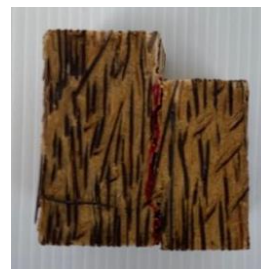
รูปที่ 19 การวิบัติเนื่องจากการรับแรงเฉือนในขนานเสี้ยนของตัวอย่าง P-C-60-30
