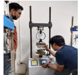
รูปที่ 17 การติดตั้งชิ้นทดสอบบนเครื่องทดสอบ
