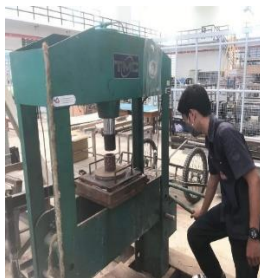
รูปที่ 7 การอัดขึ้นรูปด้วยเครื่องอัดแบบไฮดรอลิก
