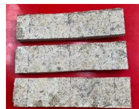
รูปที่ 12 ชิ้นทดสอบหลังการตัดขนาด 200x50 mm
