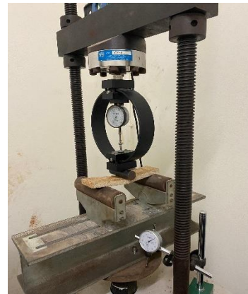
รูปที่ 18 ทดสอบความต้านแรงดัดและมอดูลัสยืดหยุ่น
