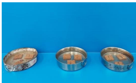
รูปที่ 15 แช่ชิ้นทดสอบในน้ำสะอาด
