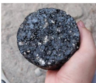
รูปที่ 6 แอสฟัลต์ซีเมนต์จากวัสดุรวม RAP ผสมหินปูนขนาด 1 นิ้ว
