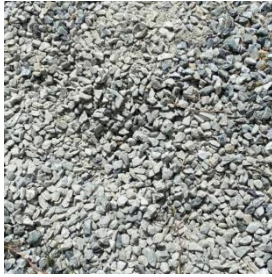
รูปที่ 2 วัสดุมวลรวมประเภทหินปูน ขนาด 1 นิ้ว (25 มิลลิเมตร) จากแหล่งโรงหินในจังหวัดกำแพงเพชร
