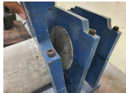
รูปที่ 6 ตัวอย่างคอนกรีตหลังทำการทดสอบ
