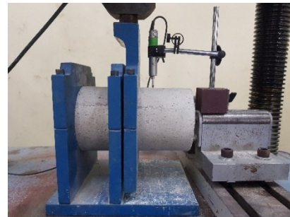
รูปที่ 5 ชุดทดสอบแรงยึดเหนี่ยวแบบเฉือนตรง
