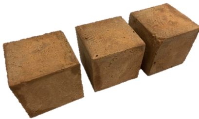
รูปที่ 3 ตัวอย่างของมอร์ตาร์ที่ใช้ Limestone Calcined Clay Cement (LC 3 )
