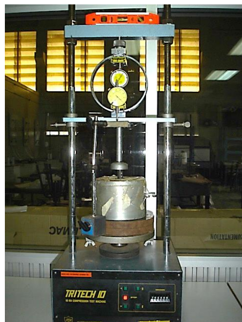
รูปที่ 10 ภาพถ่ายการทดสอบกำลังต้านทานแรงเฉือนที่ผิวแท่งเหล็กในตัวอย่างที่ปล่อยให้ระเหยในอุณหภูมิห้อง
