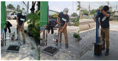
(ข) การบดอัดตัวอย่างสำหรับการทดสอบ UCS, Mr และ ITS
