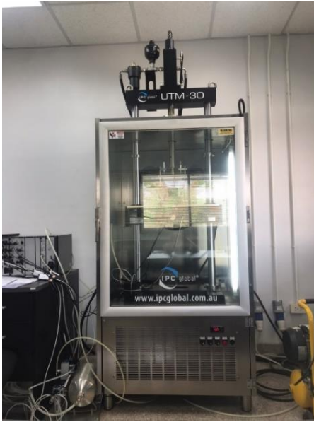
(ก) ตู้ควบคุมอุณหภูมิและโมลสำหรับการทดสอบ
