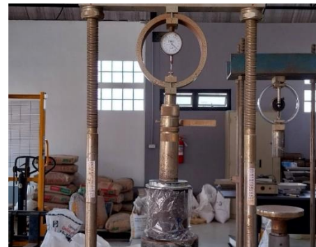
(ค) การทดสอบกำลังอัดแกนเดียวด้วยอัตราความเครียด (STRAIN RATE) ร้อยละ 0.5 ถึงร้อยละ 2 ต่อนาที
