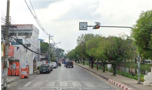
รูปที่ 9 ไฟกระพริบเตือนทางข้าม
