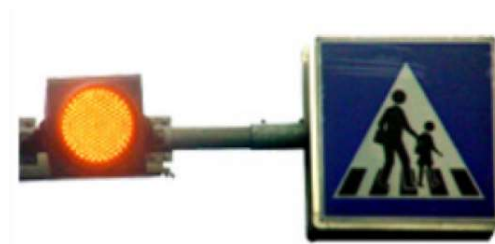
รูปที่ 4 ไฟกระพริบเตือนทางข้าม
