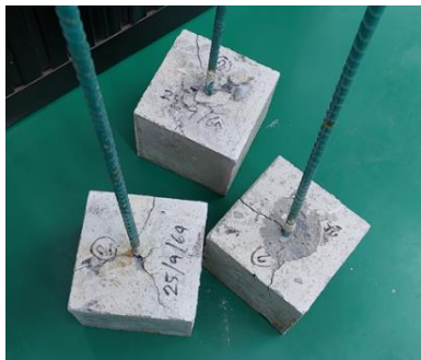
รูปที่ 16 การวิบัติแบบหลุดออกของตัวอย่างกับแท่ง GFRP ที่ระยะฝัง 100 มม.
