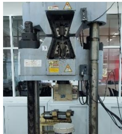
รูปที่ 10 การทดสอบแรงยึดเหนี่ยวด้วยเครื่อง Universal testing machine
