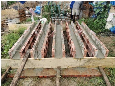
รูปที่ 8 การหล่อคานคอนกรีตที่ใช้ทดสอบ ขนาด 150x250x2000 มม.
