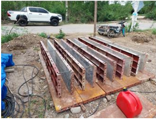
รูปที่ 5 แบบที่ใช้หล่อคานตัวอย่าง ขนาด 150x250x2000 มม.
