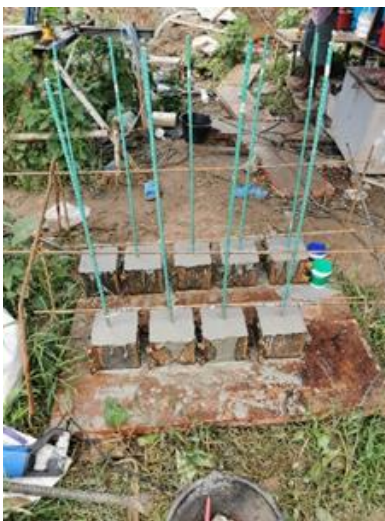
รูปที่ 2 การหล่อคอนกรีตตัวอย่างทดสอบแรงยึดเหนี่ยวทรงลูกบาศก์
