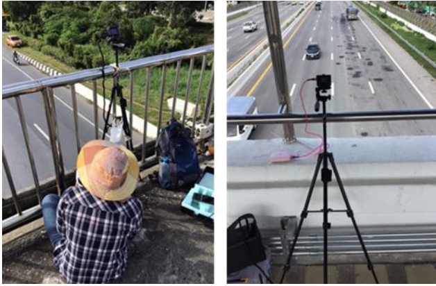
รูปที่ 4 การเก็บข้อมูลความเร็วของยานพาหนะทั้งสองสายทาง
