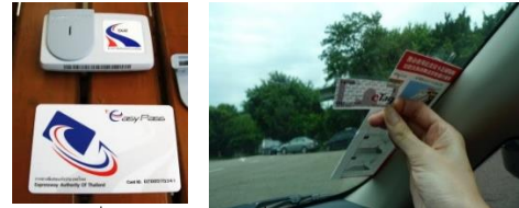
รูปที่ 2 ตัวอย่าง OBU ที่ติดบนยานพาหนะ
