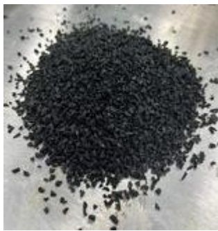
รูปที่ 2 เม็ดยางบดละเอียดขนาด 1.70 - 2.36 มิลลิเมตร
