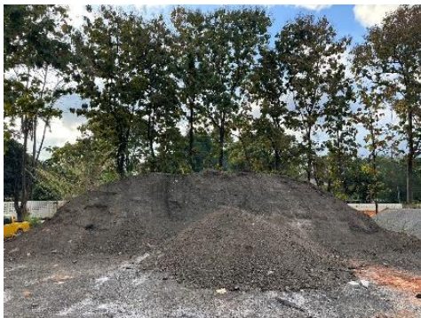
รูปที่ 1 ผิวทางแอสฟัลต์คอนกรีตรีไซเคิล
