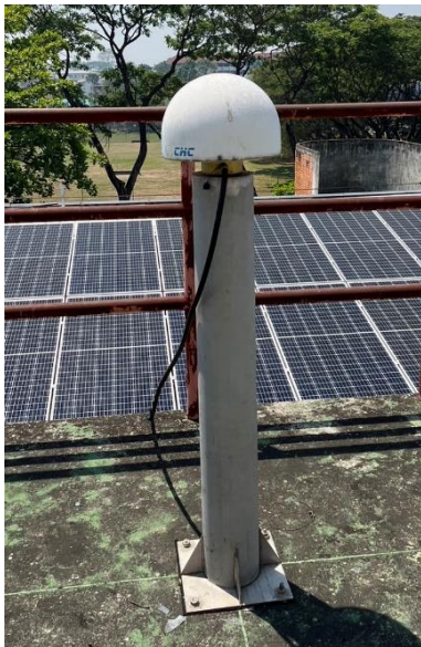
รูปที่ 4 สถานีอ้างอิงถาวรบนอาคารสำรวจภาควิชาวิศวกรรมโยธา
