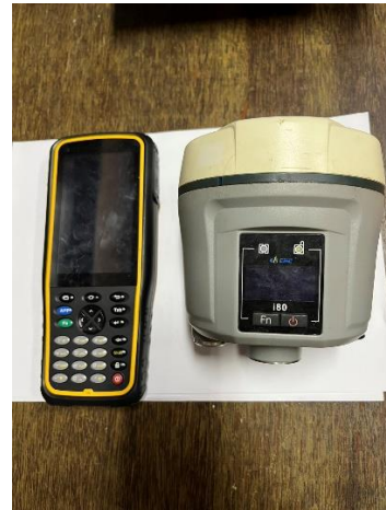
รูปที่ 1 เครื่องรับสัญญาณดาวเทียม GNSS แบบยี่ห้อเดคิก ยี่ห้อ CHC รุ่น i80
