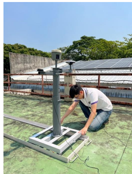
รูปที่ 6 การเลื่อนรางทดสอบเพื่อจำลองการเคลื่อนตัวทางราบ
