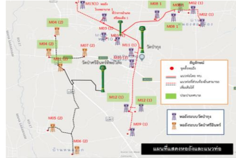
รูปที่ 4 แผนผังโครงข่ายระบบประปาเดิมของตำบลศรีสมเด็จ อำเภอศรีสมเด็จ จังหวัดร้อยเอ็ด
