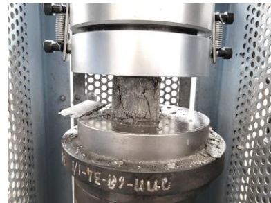
รูปที่ 3 การทดสอบกำลังอัด (Test of compressive strength)
