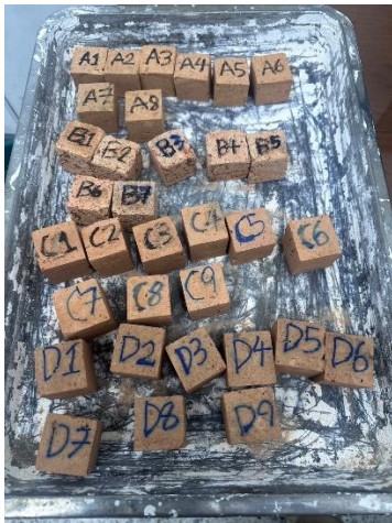
รูปที่ 3 ตัวอย่างอิฐโบราณที่นำมาตัดแต่งและขัดผิว
