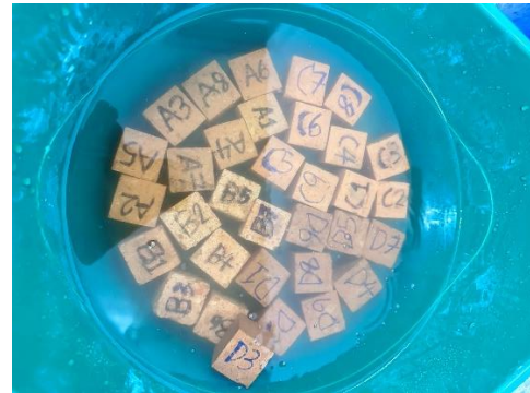
รูปที่ 4 แช่น้ำตัวอย่างอิฐโบราณ 24 ชม. สำหรับทดสอบหาความหนาแน่น
