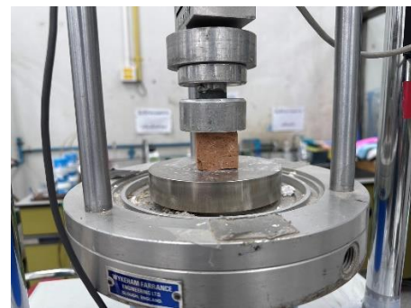
รูปที่ 5 ติดตั้งตัวอย่างทดสอบบนเครื่องทดสอบกำลังรับแรงอัดความละเอียดสูง
