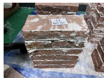
รูปที่ 2 ตัวอย่างอิฐก่อทดแทนรูปแบบปริซึมแบบมีวัสดุประสานเป็นปูนก่อ
