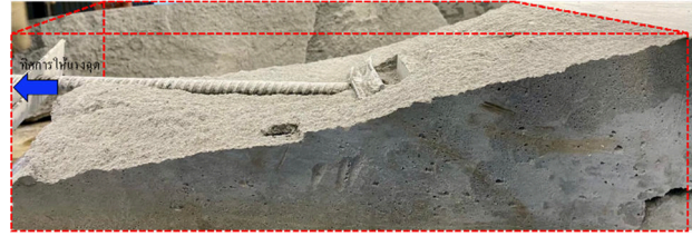
รูปที่ 6 ลักษณะการวิบัติของตัวอย่างที่ความหนาแน่น 1,250 กิโลนิวตันต่อลูกบาศก์เมตร สำหรับเหล็กเสริมกำลังแบกทาน n = 1
