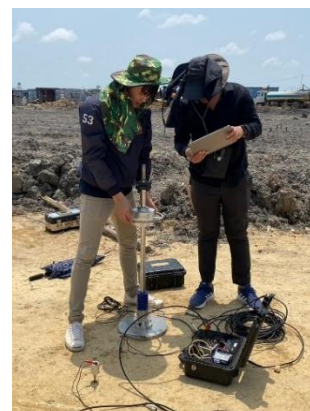
รูปที่ 1 เครื่องมือ LWD ติดตั้งเซนเซอร์วัดความเร็วคลื่น
