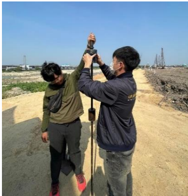
รูปที่ 3 เครื่องมือการตอกหยั่งแบบเบา
