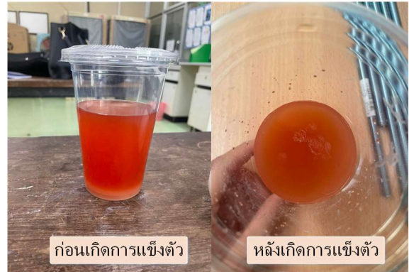
รูปที่ 10 สารละลายเคมีก่อนและหลังก่อตัวเป็นเจล
