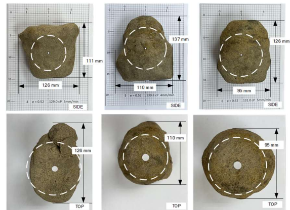
รูปที่ 19 ภาพถ่าย grout bulb ที่ความหนืด V130
