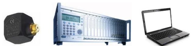
รูปที่ 10 ชุดอุปกรณ์ตรวจวัดความถี่ธรรมชาติของโครงสร้าง
