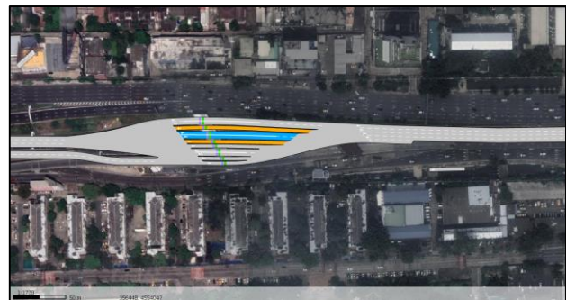
รูปที่ 7 ลักษณะโครงข่ายของแบบจำลองด้านเก็บค่าผ่านทางพิเศษดินแดง
