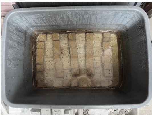
รูปที่ 11 การทดสอบการกัดกร่อนของกรวดซิลฟูริก
