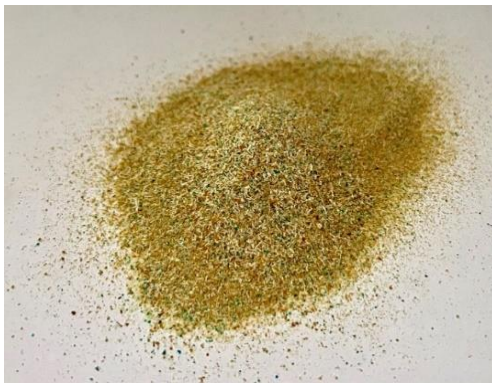
รูปที่ 3 เส้นใยจากการรีไซเคิลแผงวงจรพิมพ์
