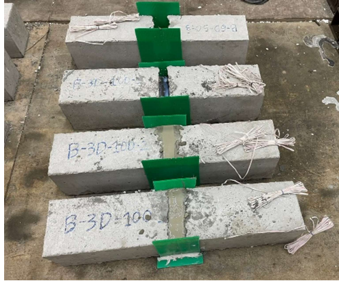
รูปที่ 4 การเชื่อมคานด้วยคอนกรีตสมรรถนะสูง
