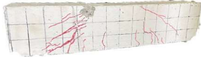
รูปที่ 23 แสดงลักษณะรอยแตกของตัวอย่าง B-0D-00
