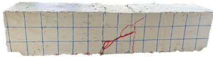
รูปที่ 21 แสดงลักษณะรอยแตกของตัวอย่าง B-9D-75
