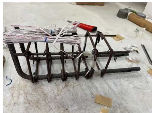
รูปที่ 2 การผูกเหล็กและติดตัววัดความเครียด (strain gauge)
