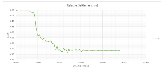
รูปที่ 20 ผลการทรุดตัวสัมพัทธ์ บริเวณรอยต่อเขื่อน
