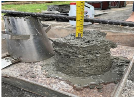
รูปที่ 2 ทดสอบการยุบตัว (Slump Test)
