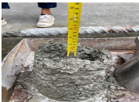
รูปที่ 4 ทดสอบการยุบตัว (Slump Test)
