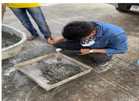
รูปที่ 5 ทดสอบการไหลของคอนกรีตสด (Flow Table Test) โดยใช้เหล็กกระทุ้งยกสูง 4 ซม. แล้วปล่อยลงมากระทบพื้นฐานถาดจำนวน 15 ครั้งภายใน 1 นาที เพื่อวัดค่าการไหลของคอนกรีตทั้ง 2 แกน
