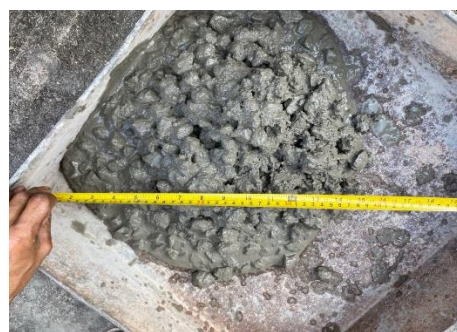
รูปที่ 7 ทดสอบการไหลของคอนกรีตสด
