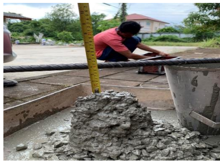
รูปที่ 3 ทดสอบการยุบตัว (Slump Test)
