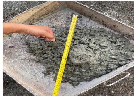
รูปที่ 6 ทดสอบการไหลของคอนกรีตสด
