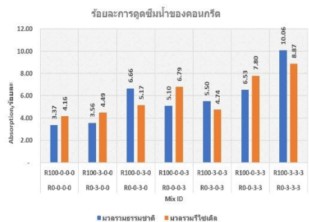
รูปที่ 11 ร้อยละการดูดซึมน้ำของคอนกรีต
