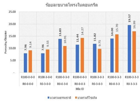
รูปที่ 10 ร้อยละขนาดโพรงในคอนกรีต
