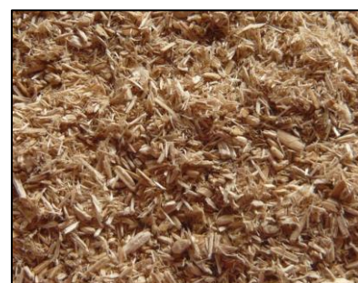
รูปที่ 2 แกนลำต้นของกัญชงที่ผ่านการสับย่อยให้มีขนาดเล็ก
