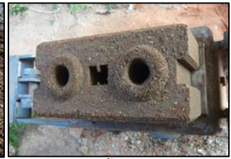
รูปที่ 9 อัดขึ้นรูปอิฐดินซีเมนต์
