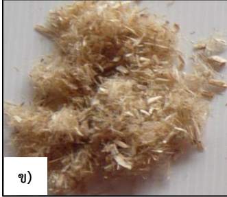
รูปที่ 3 ก) ลำต้นพร้อมเปลือกลำต้นของกัญชงที่ผ่านการสับย่อย ข) ลักษณะของเส้นใยจากเปลือกลำต้นของกัญชง
