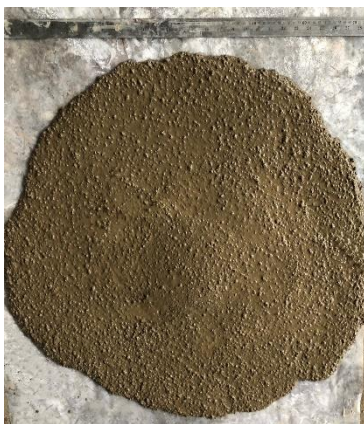
รูปที่ 5 การทดสอบค่าการยุบตัวไหลแผ่
