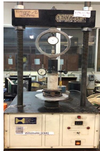
รูปที่ 6 การทดสอบกำลังรับแรงอัดแกนเดียว
