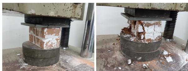
รูปที่ 5 การทดสอบกำลังรับแรงอัดของอิฐรูปแบบเต็มแผ่นตามแนวราบ ด้วยเครื่อง Universal Testing Machine (UTM)
