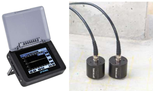
รูปที่ 4 ชุดทดสอบความเร็วคลื่นอัลตราโซนิค
