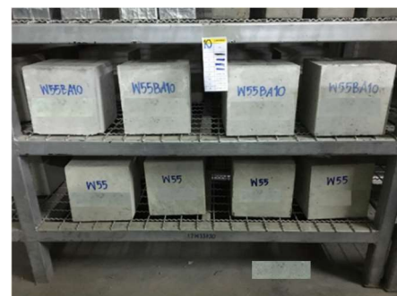
ข) ตัวอย่างคอนกรีตที่บ่มในห้องควบคุม 21 วัน
