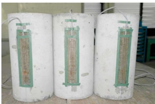
รูปที่ 5 ตัวอย่างสำหรับทดสอบโมดูลัสยืดหยุ่น [23]
