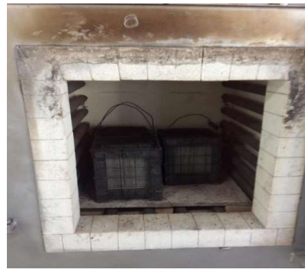
รูปที่ 2 เตาเผาไฟฟ้าสำหรับให้ความร้อนกับคอนกรีต
