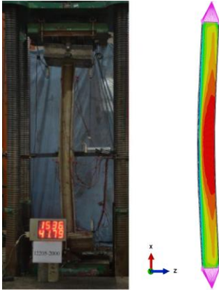
รูปที่ 4 รูปการทดสอบจริงและทดสอบด้วยแบบจำลองเชิงตัวเลข ในเสาน้ำตัดรูปตัวไอที่มีแผ่นเอวเป็นเส้นตรง [7]
