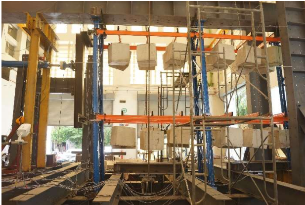
รูปที่ 8 ลักษณะการเสียรูปของตัวอย่างทดสอบ
