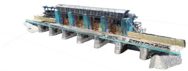
รูปที่ 5 แบบจำลองจุดกลุ่มเมฆแบบแน่น (Build Dense Cloud)
