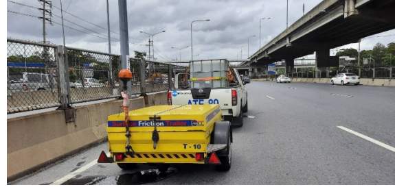
รูปที่ 20 เครื่องมือทดสอบความฝืดชนิดพวงลาก
