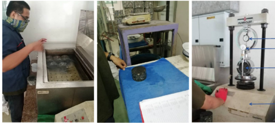
รูปที่ 13 การทดสอบ Stability & Flow
