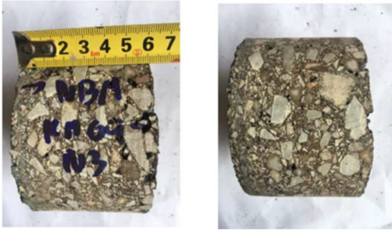
รูปที่ 5 ลักษณะและการตรวจวัดความหนาแน่นตัวอย่าง
