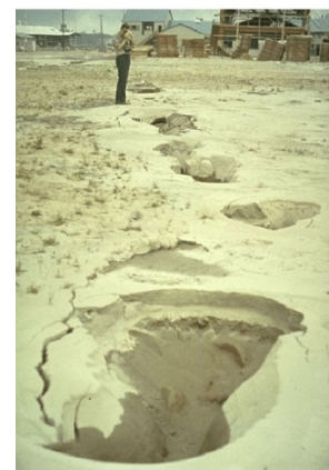
รูปที่ 3 การเกิดเหลวของดินทราย [2]
