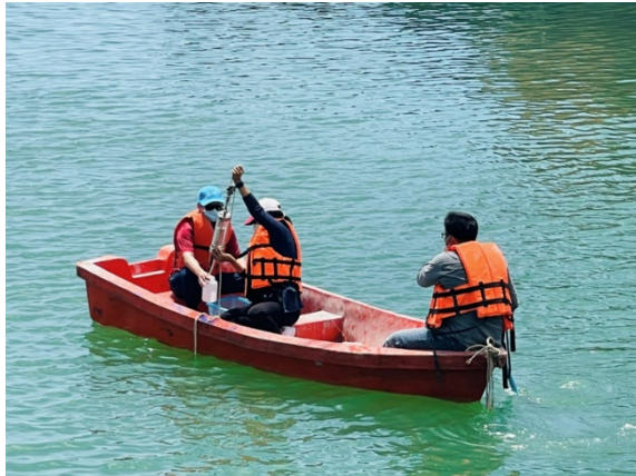
รูปที่ 5 อุปกรณ์เก็บตัวอย่างน้ำรุ่น Vertical type water sampler
