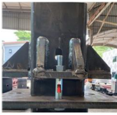
รูปที่ 10 ตำแหน่งของ Strain gage บน Bolt (B1-B4)
