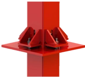
รูปที่ 1 ระบบจุดต่อระหว่างแผ่นพื้นไร้คานคอนกรีตเสริมเหล็กและเสาเหล็กโครงสร้างรูปพรรณกลวง (โพสท์คอนกรีต)
