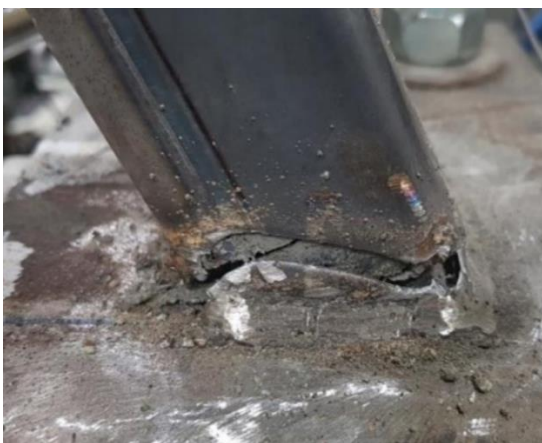
รูปที่ 13 การวิบัติของค้ำยันเหล็กกล่องของตัวอย่าง SC3
