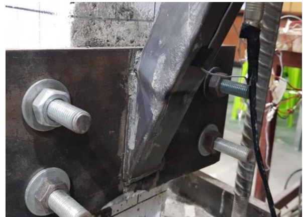
รูปที่ 10 การโก่งเดาะเฉพาะที่(Local buckling) ของค้ำยันเหล็กกล่อง
