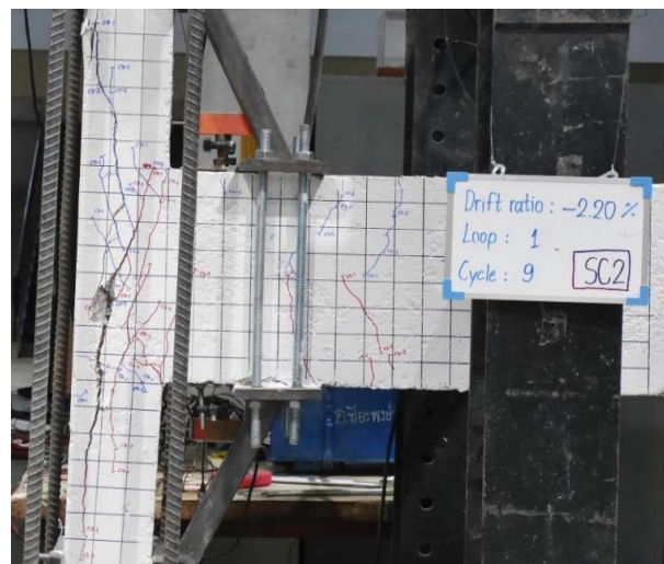
รูปที่ 11 ความเสียหายหลังการทดสอบของตัวอย่าง SC2
