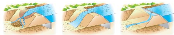
การเคลื่อนพังของลาดเขื่อนจนอาจทำให้น้ำล้นสันเขื่อน
