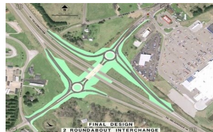
รูปที่ 3 ทางแยกต่างระดับวงเวียนคู่ ออกแบบโดย ODOT, USA (ที่มา : Ohio DOT Opens a Double Roundabout to Traffic – 2013)
