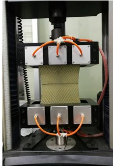
รูปที่ 3 การทดสอบหาค่ากำลังรับแรงดึงด้วยเครื่อง UTM
