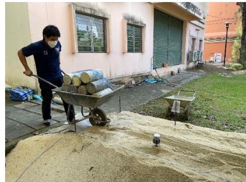
รูปที่ 12 การวิ่งผ่านของน้ำหนักเพื่อจำลองพฤติกรรมของรถบนถนน
