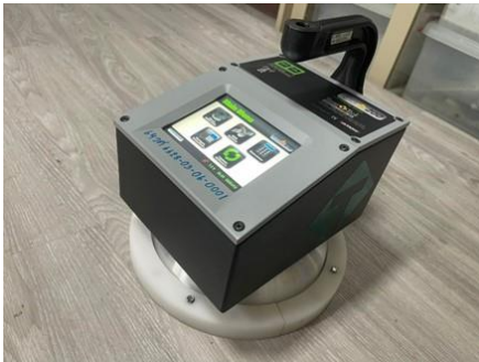
รูปที่ 9 เครื่องทดสอบหาความหนาแน่นในสนาม
