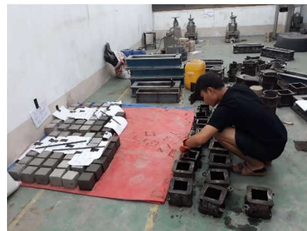
รูปที่ 9 การหล่อและจัดเก็บก้อนตัวอย่างทดสอบในห้องปฏิบัติการ
