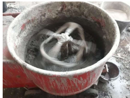
รูปที่ 8 การผสมตัวอย่างแคนนาบิสคอนกรีตและคอนกรีตปกติ
