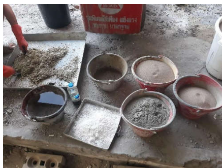
รูปที่ 7 ขั้นตอนเตรียมตัวอย่าง ซึ่ง ตวง วัสดุ และปรับปรุงคุณภาพแกนกัญชา
