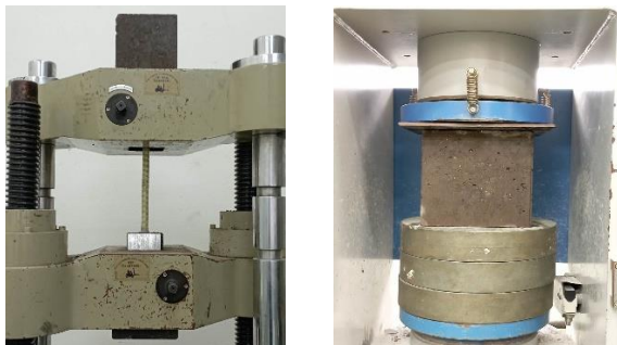
รูปที่ 2 ทดสอบกำลังรับแรงอัดและแรงยึดเหนี่ยว
