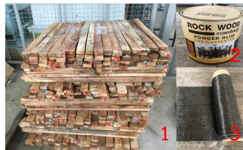
รูปที่ 1 วัสดุหลักที่ใช้ในการศึกษา 1) ไม้ยางพารา 2) กาวผง และ 3) แผ่นคาร์บอนไฟเบอร์
