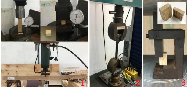
รูปที่ 2 การทดสอบ 1) สมบัติพื้นฐานของไม้ยางพารา 2) ความต้านทานแรงดึงของแผ่นคาร์บอนไฟเบอร์ และ 3) ความต้านทานแรงเฉือนของกาวยึดไม้
