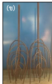
รูปที่ 2 (ก) ต้นไม้ป่าชายเลนจริง (ข) แบบจำลองลำต้นและรากต้นไม้ป่าชายเลน และ (ค) แบบจำลองต้นไม้ป่าชายเลนที่ติดตั้งในรางจำลองคลื่น
