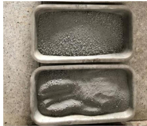
รูปที่ 3 ขนาดของบล็อกมวลเบาหลังจากถูกทุบด้วยเครื่องบดน้ำแข็ง
